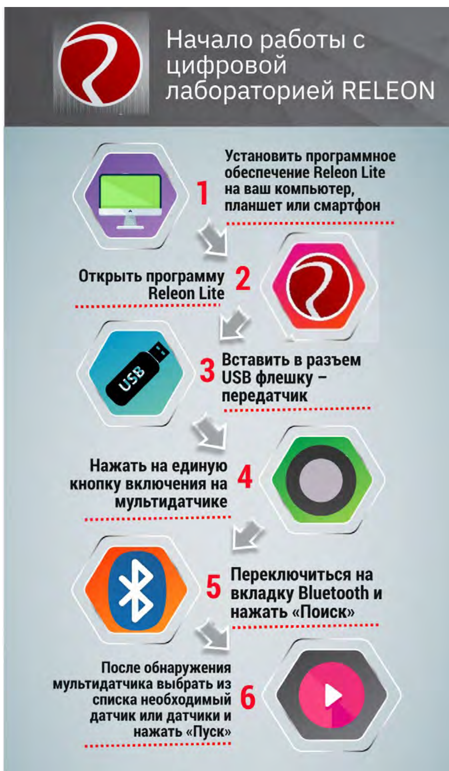
Рис. 14. Алгоритм работы с программным обеспечением Releon Lite
